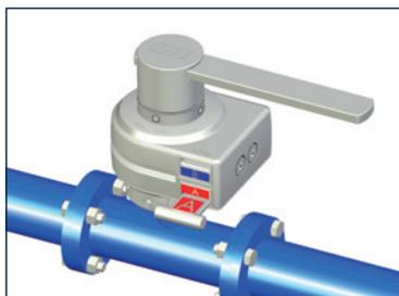
La vanne est ouverte. Cet état est matérialisé par l'inoccupation du lecteur supérieur de clé **B** (bleu) – **tOPen**. La manipulation de la vanne est impossible, elle est verrouillée. Par contre, la clé **A** (rouge) est insérée dans le lecteur inférieur.
