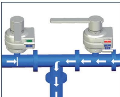
Dans cet exemple, un fluide (dans la conduite droite) doit être remplacé par un fluide différent circulant dans la conduite gauche. Il s'agit d'éviter le mélange de deux fluides.
