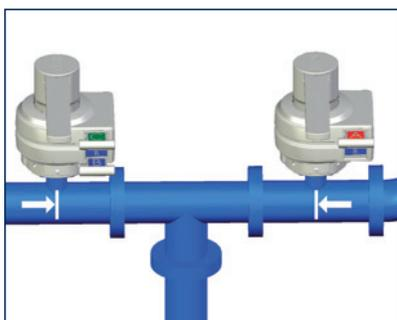
Un collaborateur habilité introduit la clé **A** (rouge) dans le lecteur du verrouillage droite. La vanne est déverrouillée et le manipulateur peut fermer la vanne droite. Sitôt que la vanne est fermée, la clé **B** (bleu) est débloquée et peut être retirée du lecteur. Dès que la clé est enlevée, la vanne est de nouveau verrouillée et ne peut plus être manœuvrée. Le fluide ne peut plus circuler dans la conduite droite.
