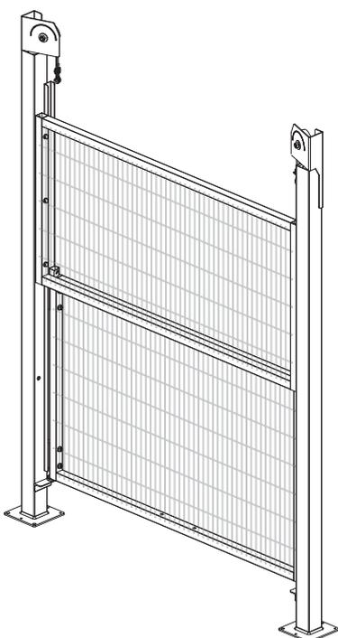
Porte équipée d'un contrepoids pour régler le mouvement d'ouverture et de fermeture. Le nombre réduit de composants rend l'assemblage simple et rapide.
