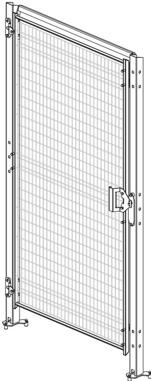
Porte pour le passage humain avec charnières, équipée d'un panneau grillagé à cadre plat soudé, de fils de 4 et 6 mm, d'une traverse supérieure de 20 x 30 mm et d'une serrure magnétique.
