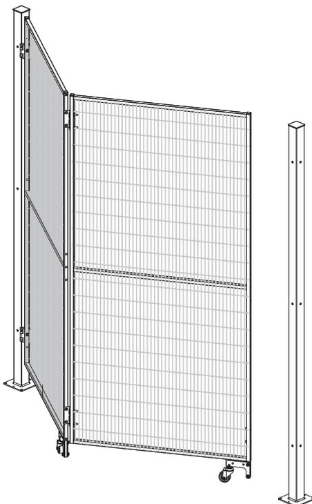
Porte articulée pour réduire l'encombrement à l'ouverture. Les deux battants se replient l'un sur l'autre pour réduire l'encombrement, tandis qu'une roulotte pivotante assure la stabilité en mouvement.
