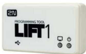
L'outil de programmation USB permet de réaliser une connexion entre l'unité vocale de cabine et un ordinateur. Le logiciel permet de configurer l'unité vocale de cabine, de changer un message vocal ou de télécharger une nouvelle version du logiciel dans l'unité vocale.
