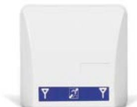
La boucle inductive est un outil pour faciliter la communication avec les personnes ayant un handicap auditif. Elle répond aux exigences de l'EN 81-70 et peut être utilisée en liaison avec chaque appareil émettant un signal sonore. Une antenne de 4 m garantit une couverture suffisante de la cabine.
