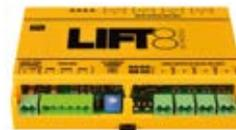
Le répartiteur permet le raccordement d'une autre gaine d'ascenseur à l'unité centrale. Un maximum de sept répartiteurs, soit huit ascenseurs, peut être raccordé à une unité centrale. Le répartiteur comprend un contact pour pouvoir bloquer l'ascenseur en cas d'un défaut.
