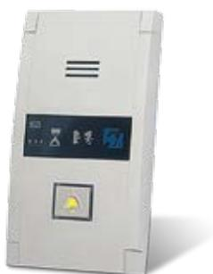
L'unité vocale de cabine avec boîtier métallique robuste comprend un bouton d'alarme de dimension prescrite ainsi que des pictogrammes rétro-illuminés derrière un panneau en verre durci. Elle offre une fixation murale simple avec une profondeur de montage de seulement 16 mm. L'unité vocale de cabine avec montage en applique convient plus particulièrement pour la modernisation des ascenseurs existants.
