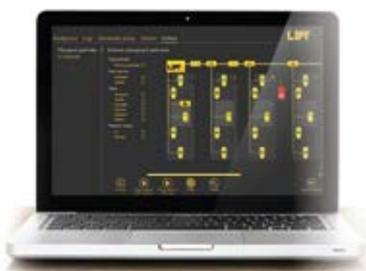
L'outil d'entretien Lift8 est un logiciel utilisé pour la configuration locale (USB) ou à distance (Remote over IP) d'un système de communication Lift8 complet (messages vocaux, module supplémentaire, répartiteur et module E/S). Il comprend une visualisation en ligne de tous les appareils raccordés, ce qui permet un contrôle rapide de l'état.
