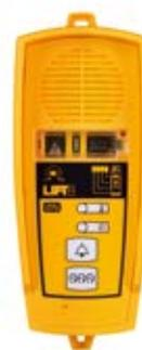
Unité vocale avec boîtier jaune robuste, pour installation en gaine ou sur le toit de la cabine. Mode "mains-libres", boutons rétro-illuminés avec fonction d'affichage pour ALARME et MODE CONFERENCE (triphonie). Ne convient pas pour un emploi à l'intérieur de la cabine.
