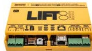
Le module caméra Lift8 peut être utilisé pour recevoir une image de la cabine d'ascenseur en cas d'appel d'urgence ou sur demande du service technique. De plus, le module caméra peut être configuré de manière à sauvegarder les images de la cabine d'ascenseur sur une carte-mémoire à des intervalles définis. En cas de vandalisme, les images de la carte-mémoire peuvent être utilisées pour identifier l'auteur.
