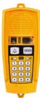
Unité vocale pour installation dans la salle des machines comprenant sirène et clavier. Celle-ci permet une communication entre la salle des machines et chaque unité vocale raccordée. De plus, elle permet de programmer l'ensemble du système Lift8 sans ordinateur. Une unité vocale pour salle des machines peut être raccordée à plusieurs systèmes de gaine.
