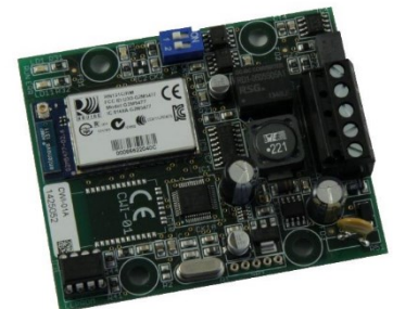
Abbildung 10 Platine CWI-01 zur Fernbedienung der Steuerung (z.B. von der Kabine aus) über ein mobiles Gerät (Handy, Tablet, Notebook).
