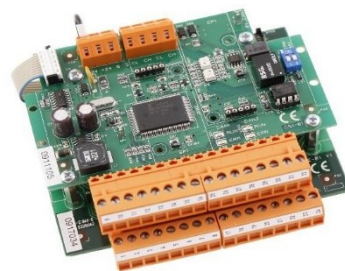
Abbildung 11 Platine CIO-01 zum Anschluss von 32 Eingängen/Ausgängen oder Rufen.
