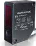
Capteur de distance laser de classe 2 basé sur la triangulation avec une résolution de 10 µm. Le modèle S67-Y est disponible en version longue portée (Y13) ou à courte portée (Y03) avec sortie analogique.
