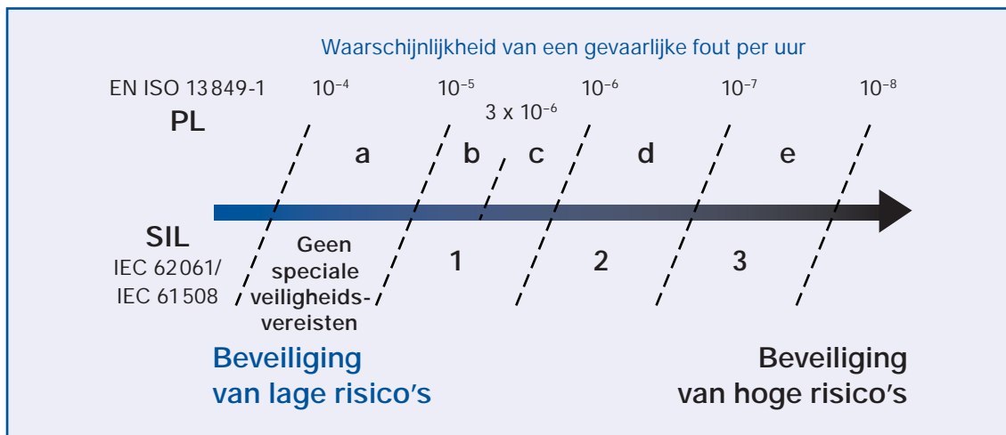
Figuur 58: Verband tussen het Safety Integrity Level SIL en het Performance Level PL
